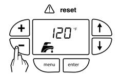
Figure 16-6: Adjusting DHW Setpoint
