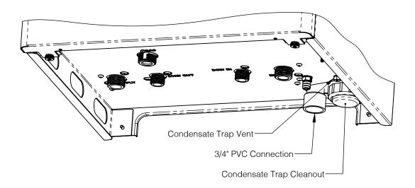
Figure 14-1: Condensate Trap
