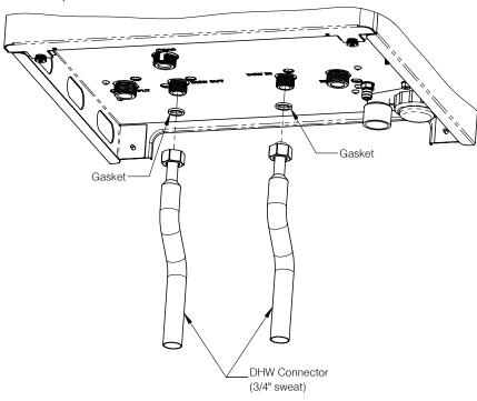
Figure 11-1: DHW Connections
