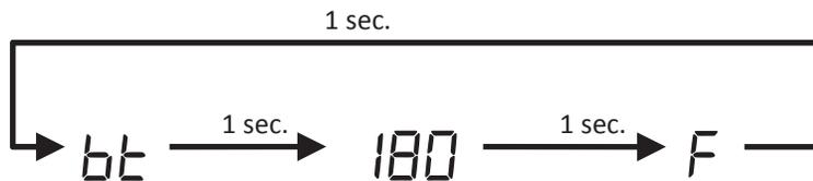
FIGURE 10b.3: TYPICAL OPERATING MODE DISPLAY (BOILER TEMP SHOWN)
